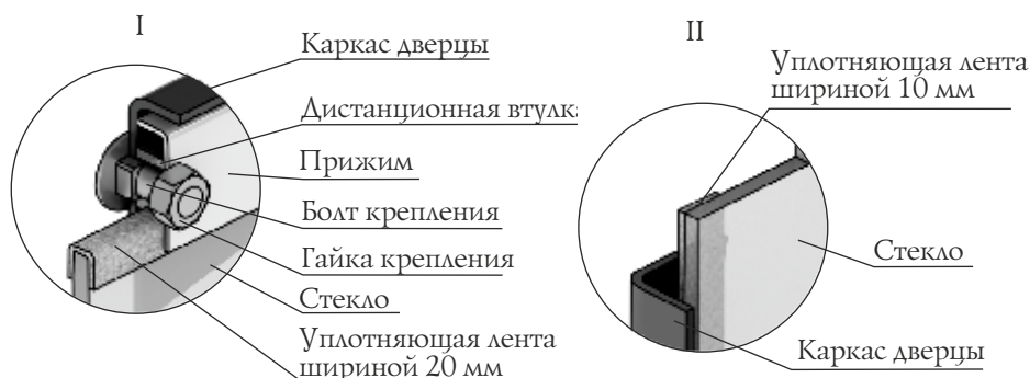
Рисунок 18. Крепление светорозрачного экрана дверцы модели «Витра»
