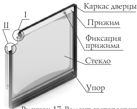
Рисунок 17. Ремонт светопрозрачного экрана дверцы модели «Витра»
