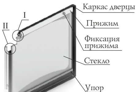
Рисунок 11. Ремонт светопрозрачного экрана двери модели «Витра»
