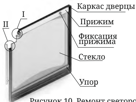
Рисунок 10. Ремонт светопрозрачного экрана дверцы модификации «Витра»
