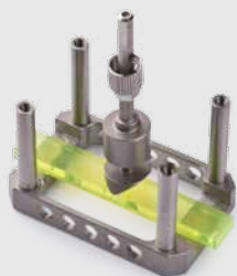
Держатель образца для 3-х точечного изгиба.
