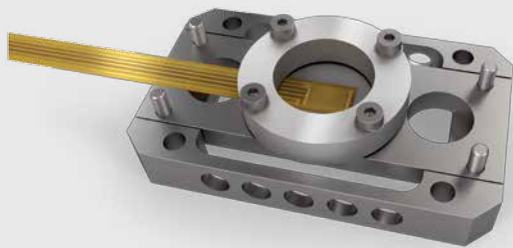
Держатель образца для синхронных ДМА-ДЭА измерений.
