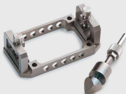
Держатель образца для одноплечевого изгиба со свободным толкателем специально используется для жестких материалов.
