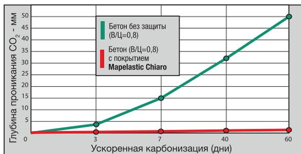
Рисунок 2. Защита пористого бетона с помощью **Mapelastic Chiaro** от ускоренной карбонизации (30% CO<sub>2</sub>)
