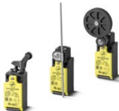
Концевые выключатели **серии FTN** из термопластика отвечают требованиям стандарта EN 50047 и могут использоваться в разнообразных конфигурациях, предполагающих замедленное или мгновенное переключение контактной группы и широкую гамму приводов. Изделия **серии FTN** легко монтируются за счет возможности повернуть головку на 90° перед установкой.
