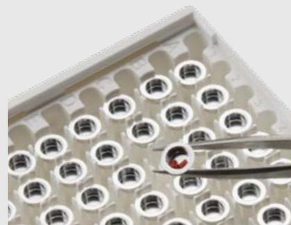
Специальный лоток предназначен для хранения проб в определенном порядке.
