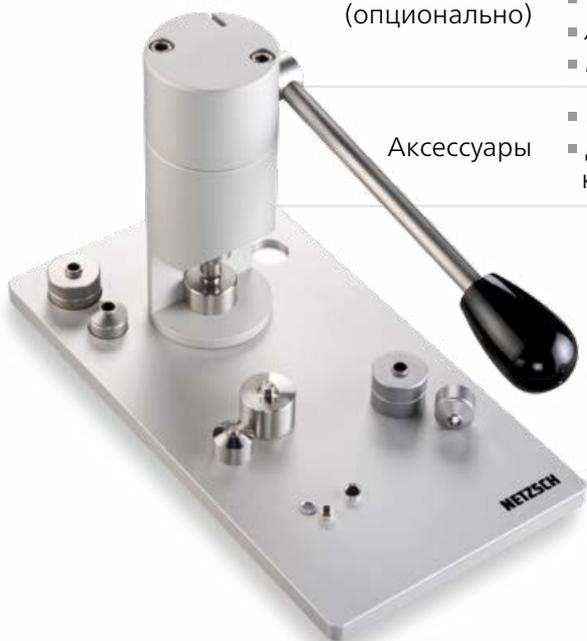
Уплотнительный пресс для различных типов алюминиевых тиглей
