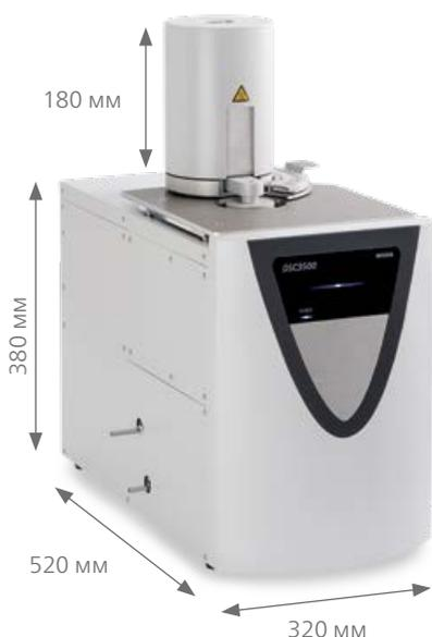
Размеры DSC 3500 *Sirius* с дополнительной системой Автоматической смены образцов (Автосэмплер)
