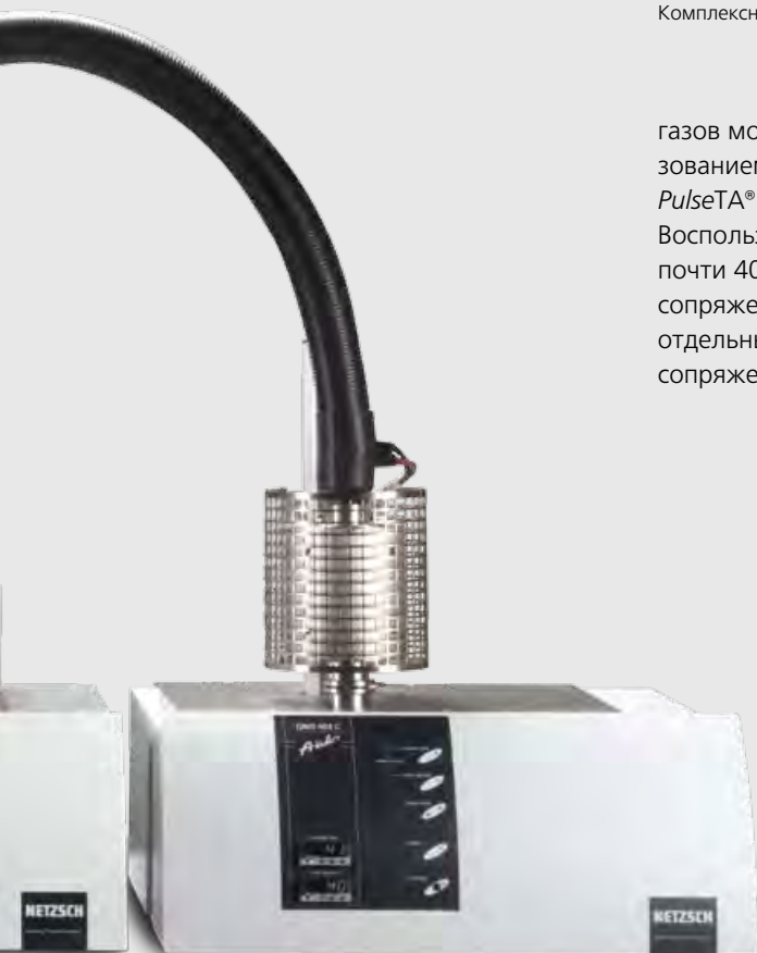
Сопряжение Tensor 27 с внешней газовой ячейкой с TG 209 F1 Libra ® и QMS 403 C Aëolos ®
