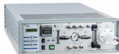
Генератор водяного пара
