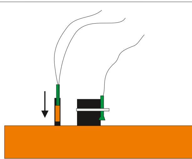
В погружную гильзу вначале опускается датчик центрального отопления, а за ним датчик термозащиты. Как вариант, допускается установка датчика термозащиты на патрубке подающего трубопровода котла (до гайки подключения), при этом, прижатие его к патрубку должно выполняться металлическим хомутом. Добавление каких-либо жидкостей в погружную гильзу запрещено!
