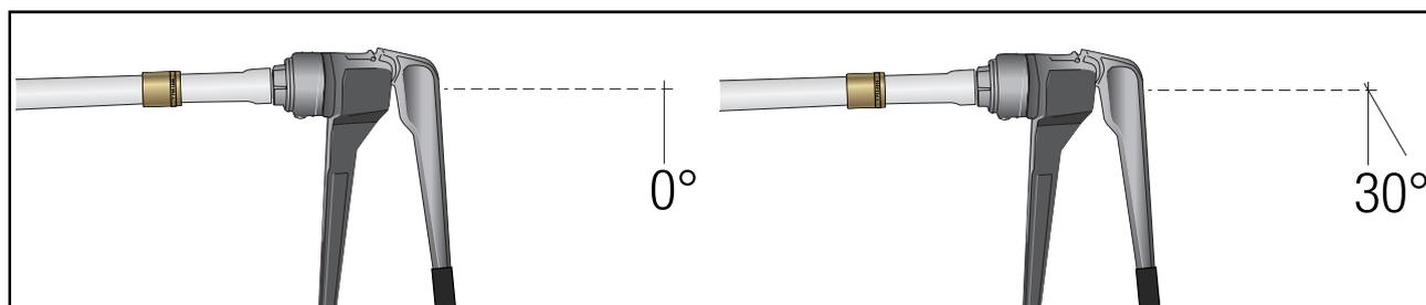
4.3 Монтаж фитингов из PPSU должен осуществляться при температуре окружающей среды не ниже 0 °С специально предназначенным для этого инструментом.
