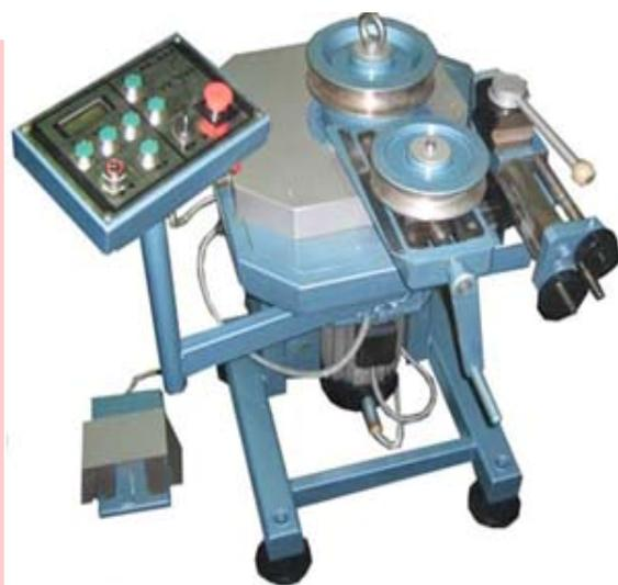
Стандартная комплектация из шести сменных колодок предназначена для **гибки** водо-газопроводных **труб** по ГОСТ 3262-75, диаметром от 1/2" до 2" и толщиной стенки от 2 мм до 4,5 мм (см. Таблицу №2)
