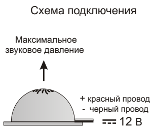
Рис.2 Схема подключения и диаграмма направленности оповещателя.
