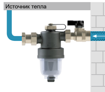
Рис. 2 Установка сепаратора ADS 110 на горизонтальный трубопровод
