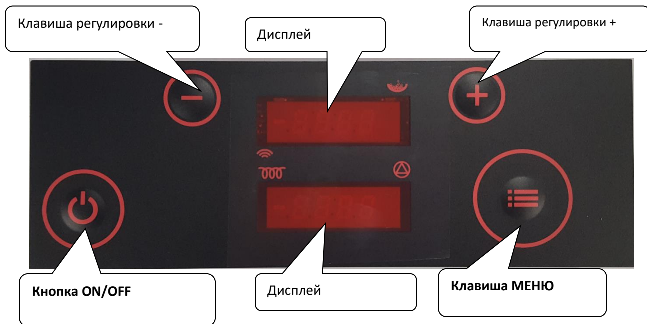
Рис. 14: Сводка кнопок клавиатуры (пластмассовая клавиатура):
