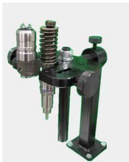
Установка в струбцине насос-форсунки SCANIA Ч-образной
