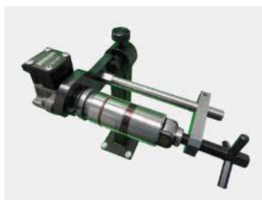
Установка в струбцине насосной секции MB ACTROS
