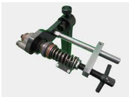
Установка в струбцине насосной секции Delphi 082240354
