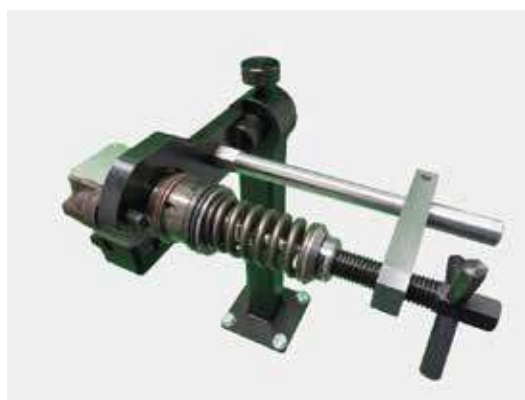
Установка в струбцине насосной секции DAF Bosch 0414755005
