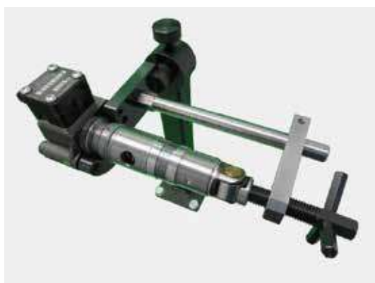
Установка в струбцине насосной секции MB ATEGO
