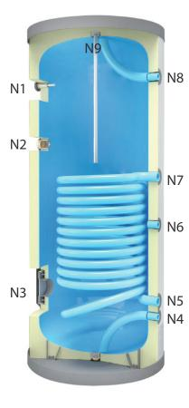
Ёмкость из чёрной стали S235JR со змеевиком косвенного нагрева, покрытая изнутри высококачественной стеклоэмалью (в соответствии со стандартом DIN 4753-3), и предназначенная для приготовления горячей воды.
