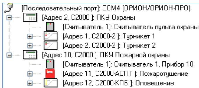
Рисунок 27. Дерево объектов протокола "Орион Про"
