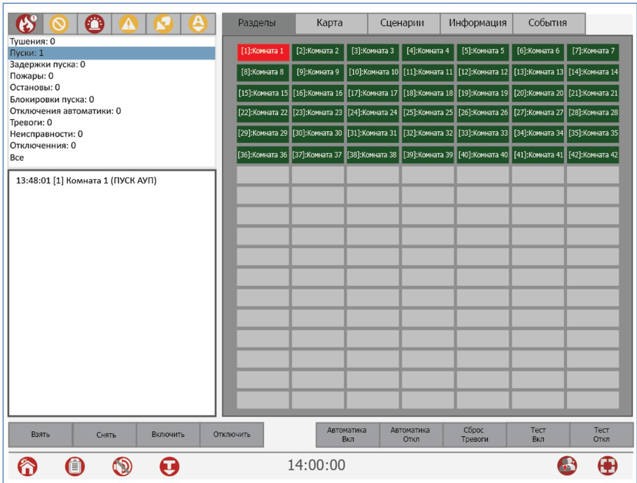
Рисунок 53. Отображение режима "Пуск" на дисплее пульта
