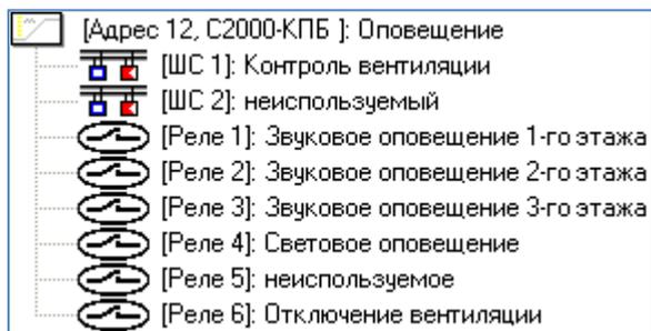
Рисунок 36. Пример отображения релейных выходов блока "С2000-КПБ"
