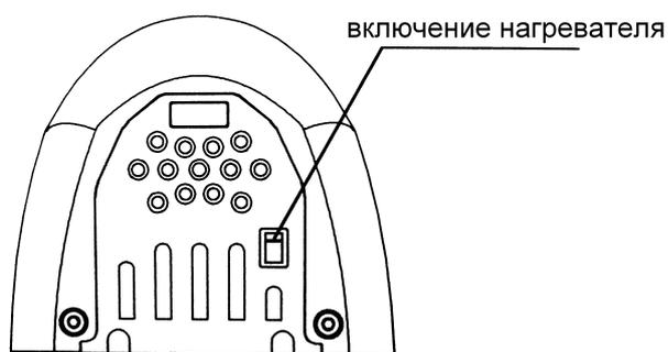
Выключатель нагревающего элемента находится в нижней части устройства. Переключите в положение ON для теплого воздуха и OFF для холодного.
