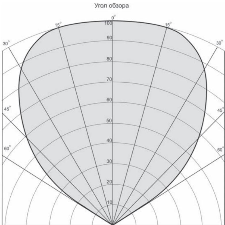
Рисунок 3 - Зависимость дальности обнаружения очага пламени от его углового положения в поле зрения извещателя, в процентах от максимального значения.
