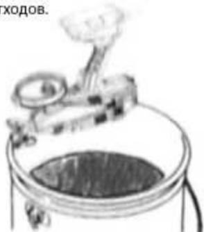
4. Вставьте сопло защитной жидкости насоса во входное отверстие и сильно надавите до упора. Сжимайте бутылочку для чистки до тех пор, пока раствор для ухода не вытечет из сливной трубы.
