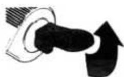
2. Установите фильтр сопла на узел сопла/расширительной втулки.
