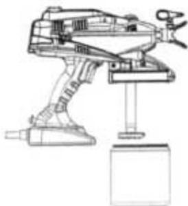
3. Чтобы наполнить распылитель жидкостью, нажмите на спусковой крючок распылителя в течение 10 сек. Затем отпустите. Нажмите на спусковой крючок и потяните обратный клапан в нижнее положение (положение распыления).
