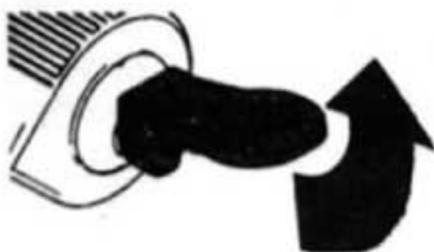
3.Потяните обратный клапан в нижнее положение (положение распыления).
