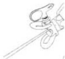
Важно! Для достижения наилучших результатов при очистке не распыляйте с помощью сопла больше, чем стакан воды. Если требуется дальнейшая промывка, снимите сопло с распылителя.
