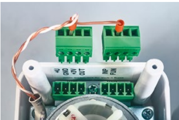
Фото 22. Подключение проводного выключателя
