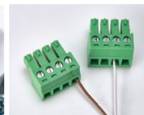
Фото 14. Подключение провода датчика к ответной части разъема
