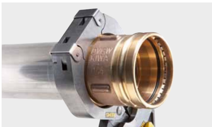
Пресс-клещи REMS (PR-3B) с 3 «плавающими» пресс контурами для обжима фитингов больших размеров, к которым предъявляются особые требования. Оптимальный обжим благодаря радиально направляющему движению «плавающих» пресс контуров, с промежуточной фиксацией.
