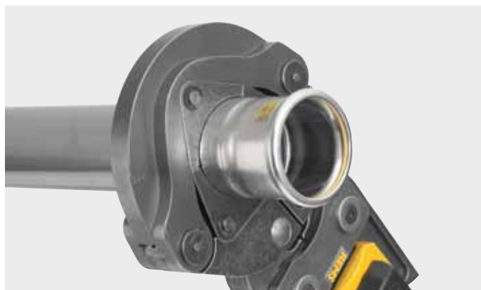
Пресс-шайба REMS (PR-3S) с 3 запрессовочными сегментами, установленными на поворотном шарнирном кольце, для осуществления запрессовок больших размеров, к которым предъявляются особые требования. Оптимальное прессование обеспечивается радиально управляемым движением пресс-сегментов, с промежуточными клещами.
