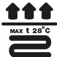
Теплые полы на базе регулируемых пленочных электронагревателей могут быть пригодны для использования с ламинированными полами, если изготовитель нагревателя обеспечивает, что температура поверхности никогда не превысит 28°C. Стандартные теплые полы на базе пленочных электронагревателей при экстремальных перепадах температуры вырабатывают температуру поверхности, намного превышающую 28°C, и поэтому считаются непригодными в качестве основания для укладки.
