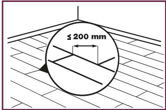
3. Сборку второго и последующих рядов начните с соединения половиц ряда между собой по поперечной стороне.
