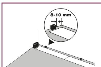
8. Во всех дверных проемах, переходах, помещениях со сложной конфигурацией, а также помещениях, имеющих более 10 м в длину или ширину, следует вставлять переходники/порожки.
