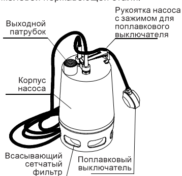
Рис. 1 Конструкция насосов Unilift AP
