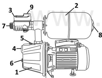
Станция состоит из следующих основных узлов: поверхностного насоса (1), гидроаккумулятора (2) и блока управления (3). Насос имеет входное отверстие (4) для присоединения всасывающей магистрали, а также заливное (5) и сливное (6) отверстия. Напорная магистраль присоединяется к выходному патрубку блока управления (7). На корпусе гидроаккумулятора находится пневмоклапан (8) для регулировки давления сжатого воздуха.
