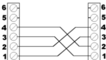
**СОЕДИНЕНИЕ:** Соединение между двумя *Brio Top* может быть выполнено при помощи экранированного кабеля 4x0,5 мм<sup>2</sup>, как показано на схеме рядом. Максимальная длина кабеля составляет 100 см, включая оголенные части. Имеется предварительно собранный соединительный кабель с клеммами и нумерацией кабелей (код SR-CBL4X05-100).
