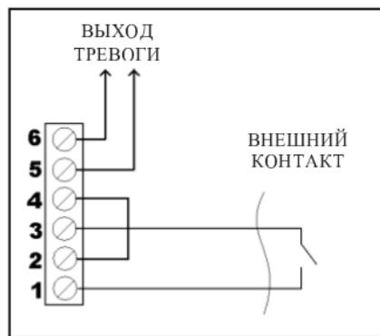
**Параметр “Con. Aus.” = 3 – Внешнее включение и сигнал работающего насоса.**
