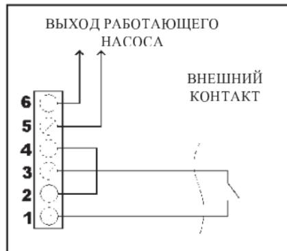
**Параметр “Con. Aus.” = 4 – Соединением с инвертером “Sirio”**
