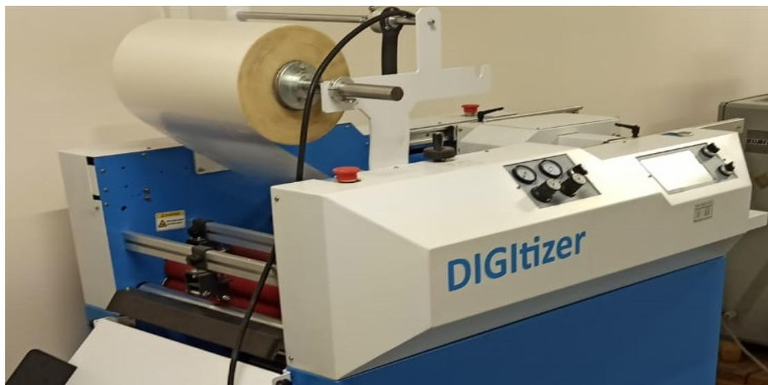
2-сторонний ламинатор без отрыва для цифры Yellow 490 шириной 490 мм;
