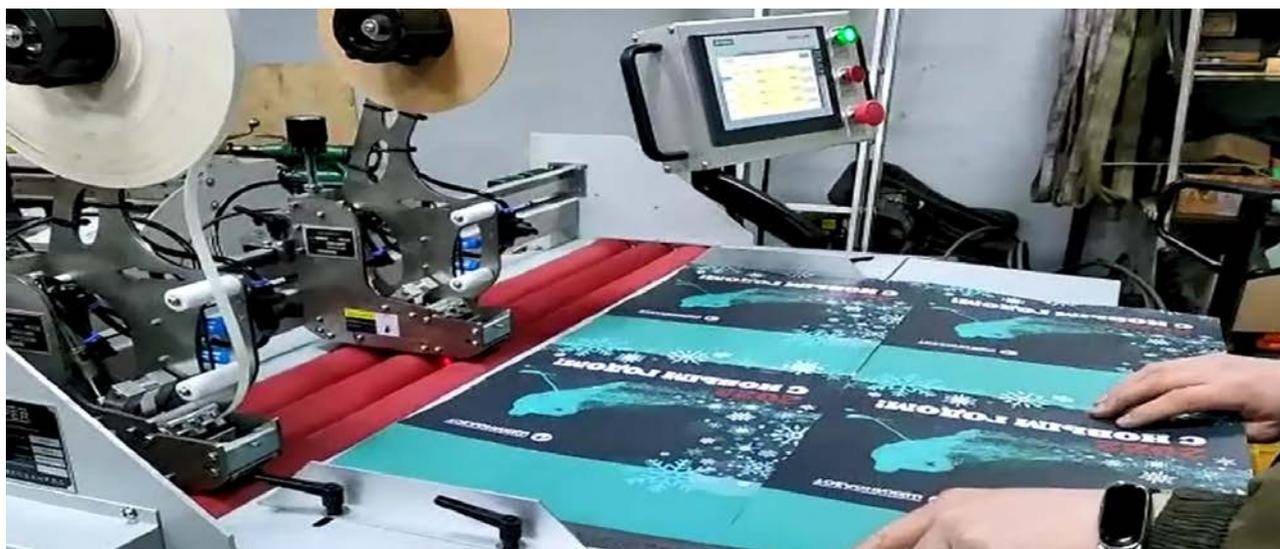
**Аппликатор-Автомат POLYTAPER-800 AUTO**, автоматическая подача и приемка в лоток,
