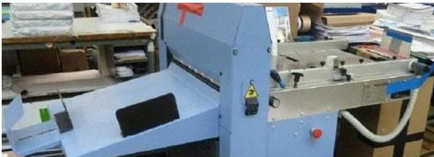
**RD-480 полуавтоматическая биговальная машина 480 мм шириной** - <https://pmachine.ru/rongda-rd-480/>
