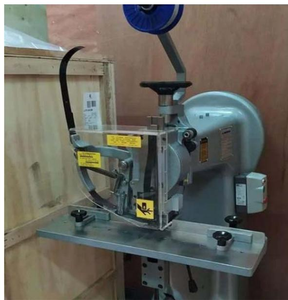
**1-головочная проволокошвейка Yellow 100 для цифры** – пробивка до 6 мм -
