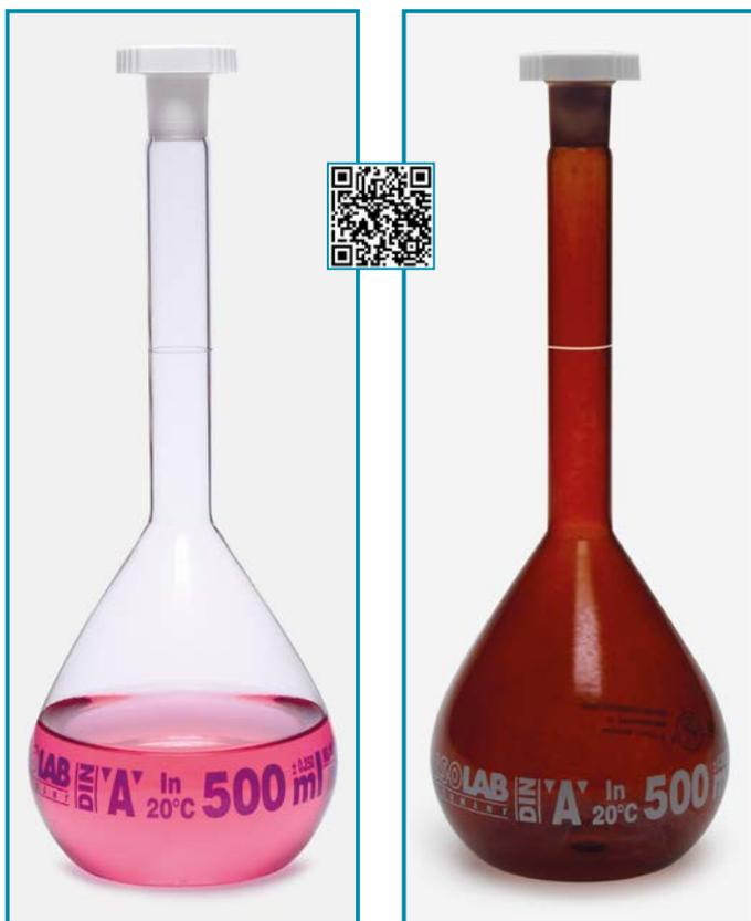
➤ Изготовлены из жаропрочного боросиликатного стекла 3.3 в соответствии со стандартом DIN EN ISO 1042. Выполнена калибровка автоматическими роботами в соответствии со стандартом DIN/ISO, класс «А».
