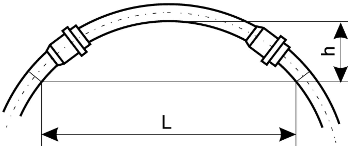
**Таблица 3 Максимальный размер  $h$  и радиус изгиба  $R$ , в м. при длине  $L$ :**
