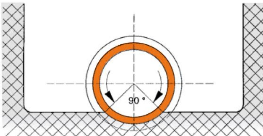
Во избежание линейных или точечных опор, зона под трубой не должна быть твёрже остального опорного слоя. С другой стороны, нельзя допускать взрыхления дна траншеи, например, зубьями экскаватора или размачивания водой. Если произошло разрыхление или размягчение, то нужно восстановить первоначальную плотность дна траншеи.
