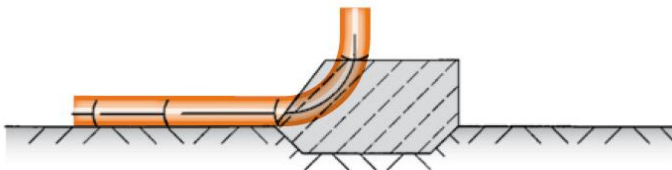
Таблица 9 **Осевая и результирующая силы в кН в зависимости от угла изменения направления, при внутреннем давлении 0,5 атм.**
