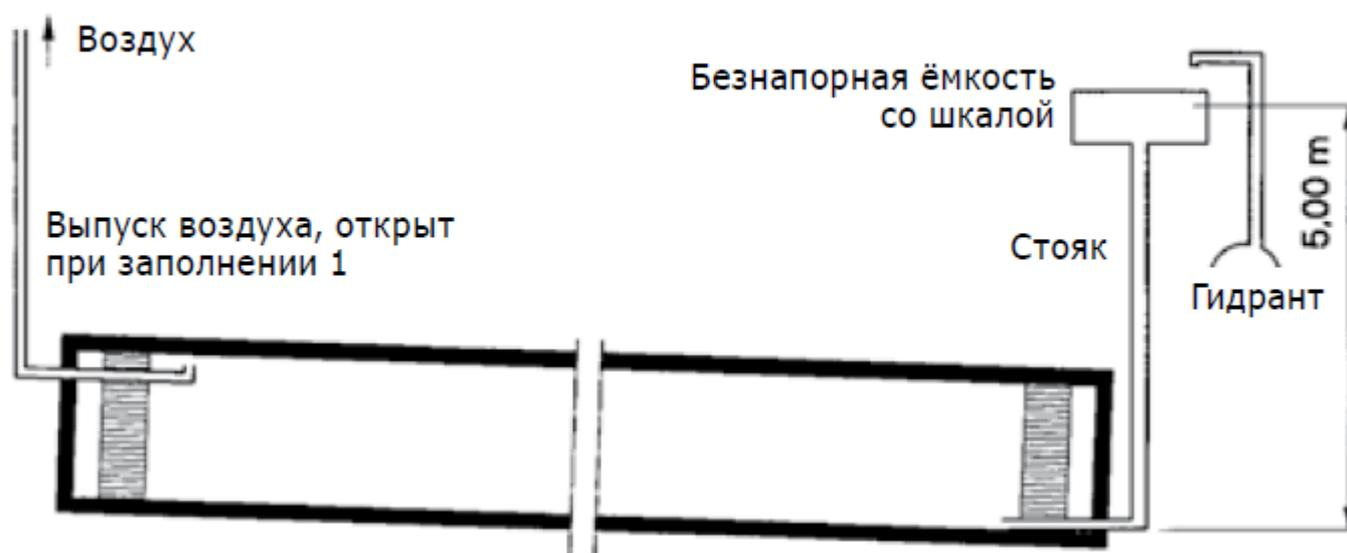
Между заполнением и испытанием трубопровода должно пройти достаточное время (1 час), чтобы оставшийся в трубопроводе после заполнения воздух мог постепенно выйти наружу. Испытательное давление измеряется в самой нижней точке испытываемого участка. Безнапорные трубопроводы должны проверяться с избыточным давлением 0,5 атм. Испытательное давление, создаваемое в начале испытаний, следует поддерживать добавлением воды в течение 30 минут. Измеряйте количество добавляемой воды.
