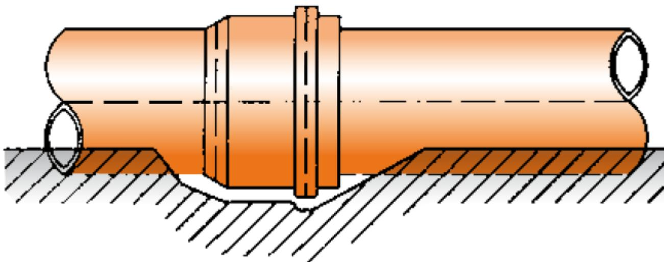
Опорная поверхность увеличивается при послойной засыпке и уплотнении рыхлым поддающимся уплотнению материалом, и опорный угол становится больше по сравнению с предварительно сформированным углом. Таким же образом можно укладывать трубу на ровное дно (тип основы 3), если опорная поверхность изготовлена подтрамбовыванием и уплотнением рыхлым способным утрамбовываться материалом и гарантировано, что боковая уплотненная засыпка будет как минимум такой же плотности, как и дно. Для этих
