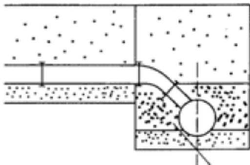
Подключение в засыпном слое при любом перепаде уровней прокладки, угол входа 45°
