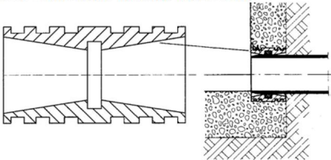
Гильзы прохода через стену применяются для входных и выходных труб, они устанавливаются внутри заподлицо со стенкой колодца и по завершении монтажа заливаются бетоном. Гильзы позволяют вставленной трубе отклоняться на  $3^\circ$ .
