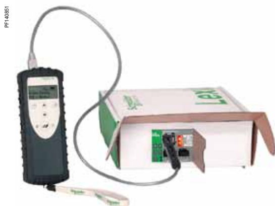
Конфигурирование Lexium Easy 26 (без подачи питания) при помощи универсального мультизагрузчика VW3A8121 Multi-Loader tool и соединительного кабеля VW3A8126
