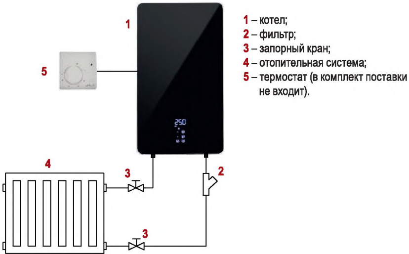
Рисунок 19 - Подключение термостата (в комплект поставки не входит)
