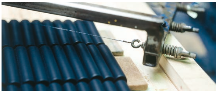
Pastelle werden mit einem drahtbespannten Rahmen zugeschnitten / Wire-strung frame for cutting the pastels
