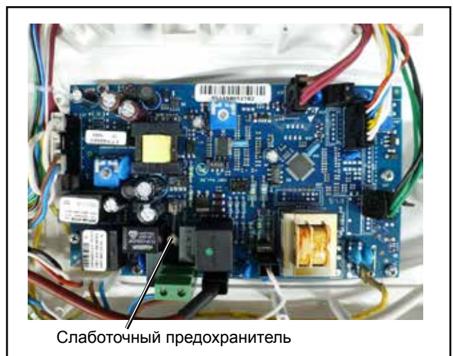
Рис. Замена предохранителей
