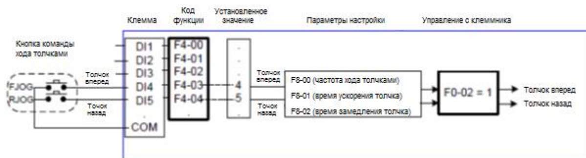
Рис. 5-15. Ход толчками в режиме управления с клемм DI
