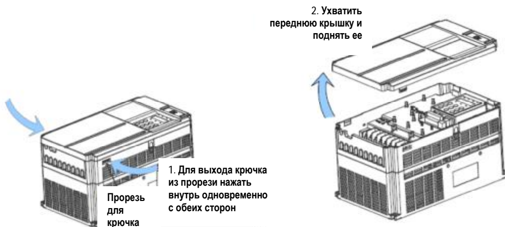
Рис. 3-13. Снятие передней крышки MD290 (металлический корпус)
