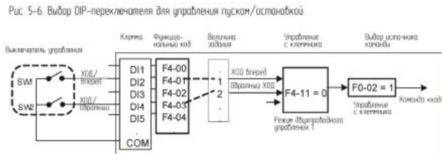
Рис. 5-6. Выбор DIP-переключателя для управления пуском/остановкой
