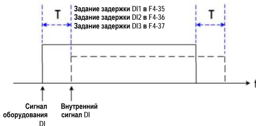
Рис. 5-30. Задание функции задержки сигнала DI
