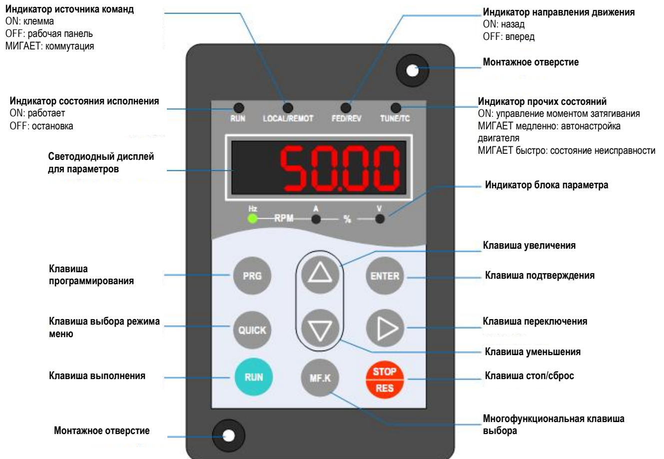
Рис. 5-1. Детали рабочей панели
