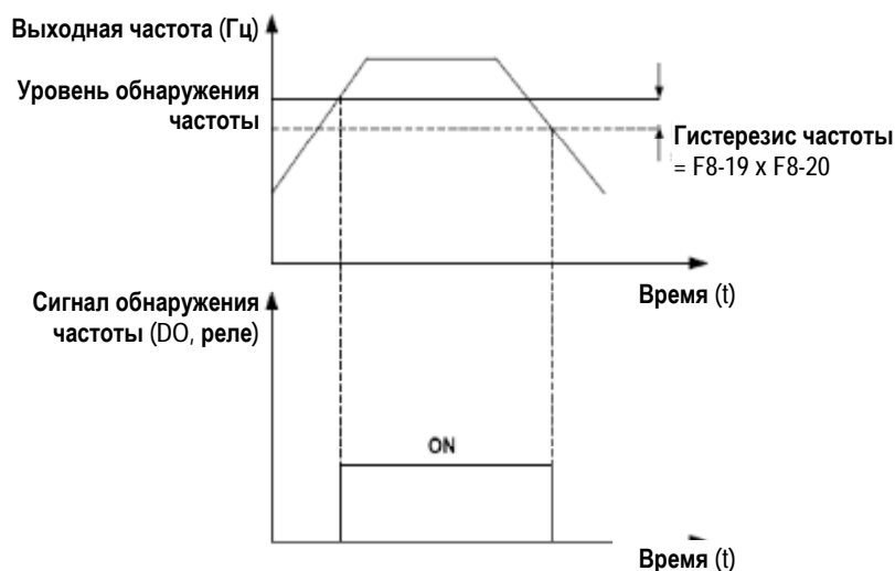
Рис. 7-23. Функция обнаружения частоты
