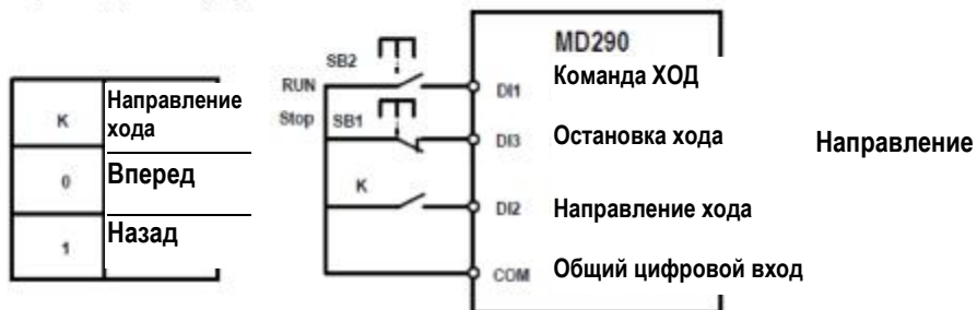
Рис. 7-14. Режим трехпроводного управления 2
