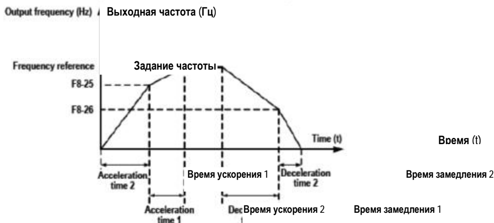
Рис. 7-26. Переключение между временем ускорения и временем замедления
