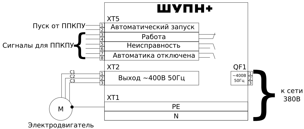
Рис. 1: Схема внешних подключений для управления одним насосом 380В
