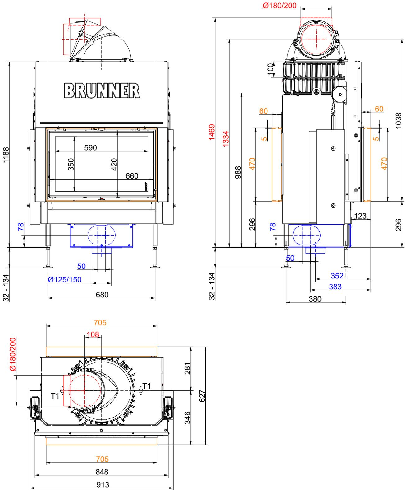
... Schiebetür/Drehtür mit Anbauahmen/Anbaukante und Wärmetauscherringe Guss + Gusskuppel
