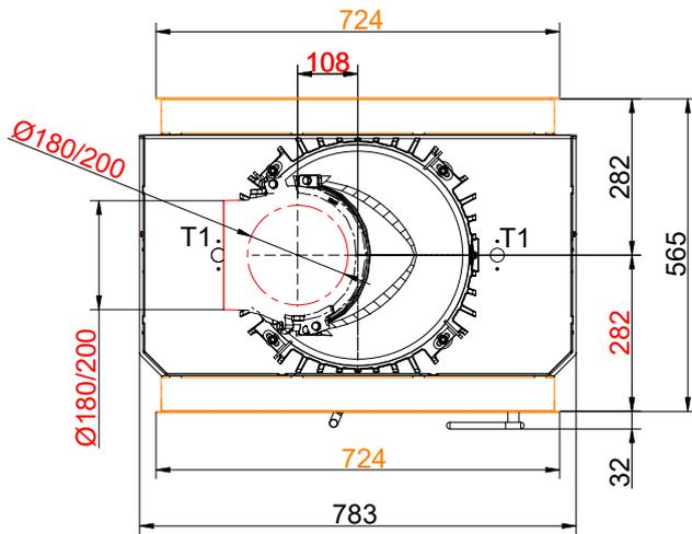
... Drehtür/Drehtür mit Blendrahmen und Wärmetauscherringe Guss + Gusskuppel
