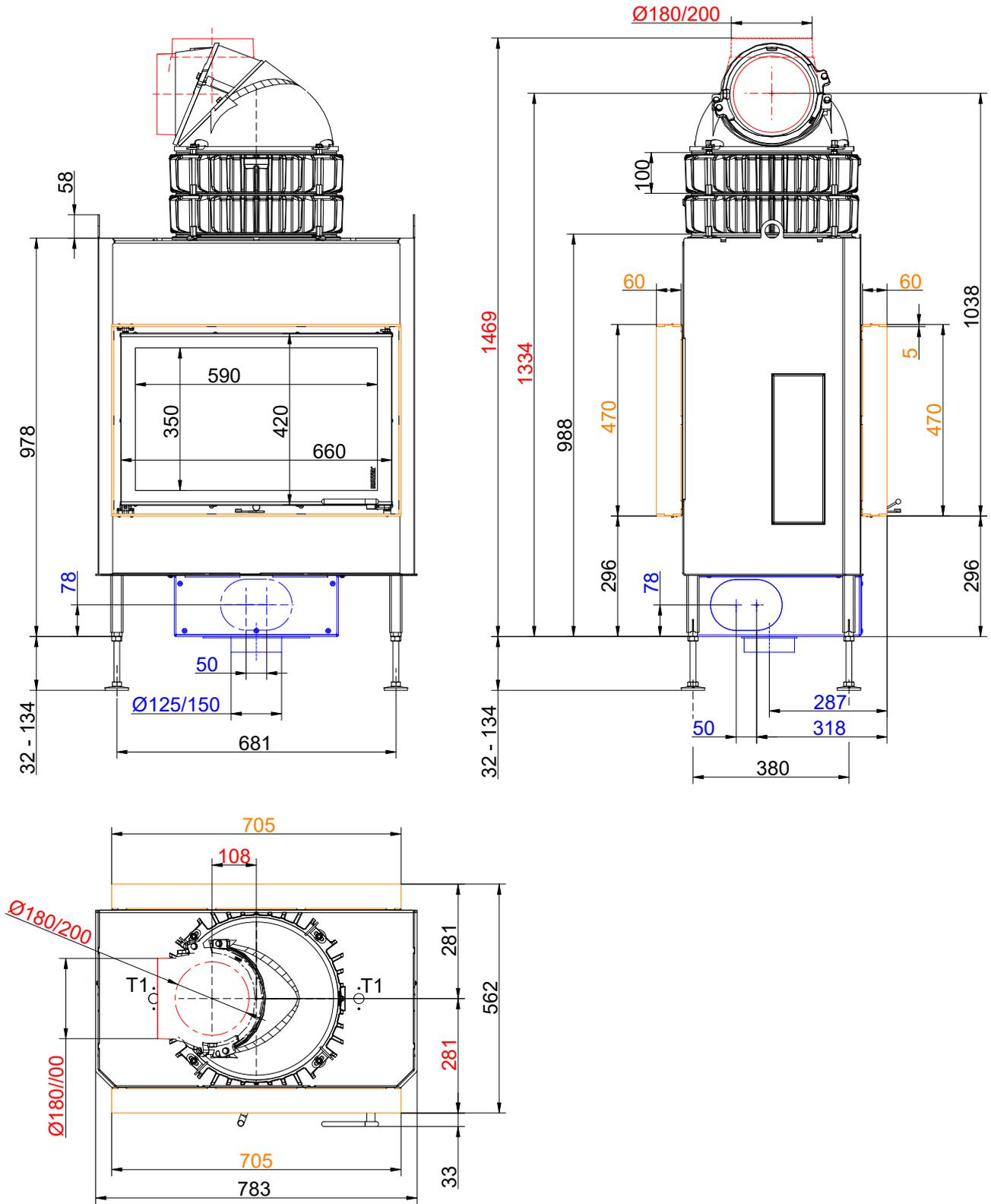
... Drehtür/Drehtür mit Anbaukante und Wärmetauscherringe Guss + Gusskuppel
