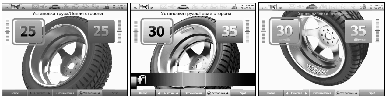
а – установка груза в «12 час» б – установка груза линейкой в – очистка
