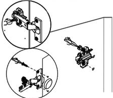
Регулирование зазоров и положения дверей с петлями
