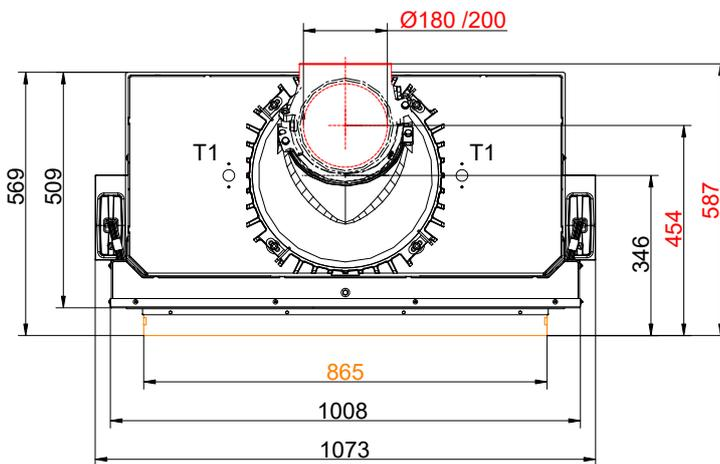
... Anbaurahmen und Wärmetauscherringe Guss + Gusskuppel
