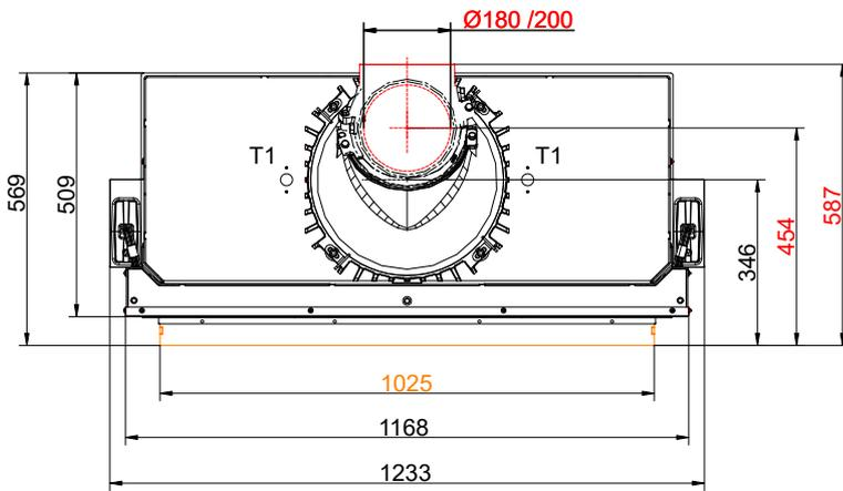
... Anbaurahmen und Wärmetauscherringe Guss + Gusskuppel
