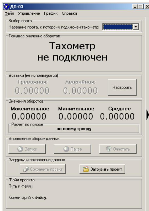
Рис. 24. Окно приложения с не выбранным портом тахометра
