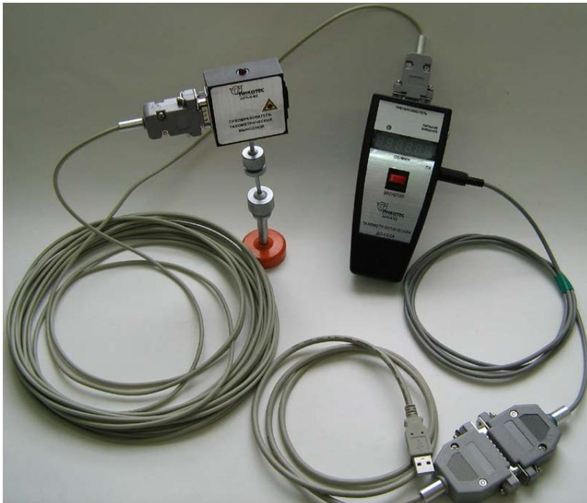
Рис 1г. Тахометр оптический ДО-03-04.
