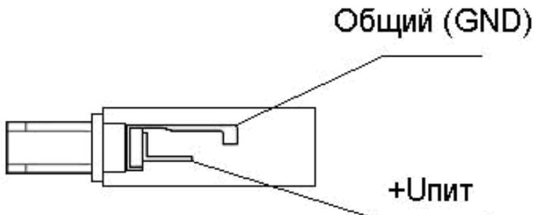
Рис. 40. Назначение выводов розетки внешнего питания.
