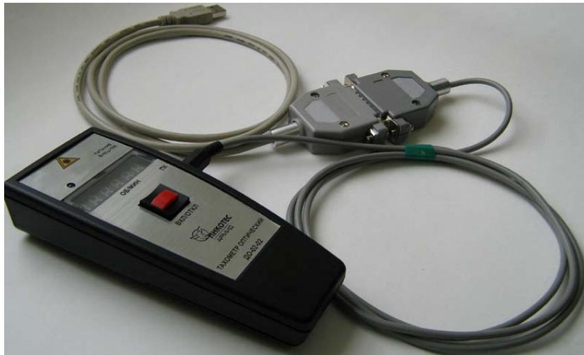
Рис.1б. Тахометр оптический ДО-03-02.
