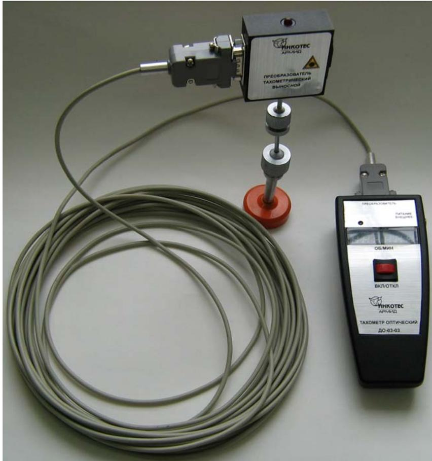
Рис 1в. Тахометр оптический ДО-03-03.
