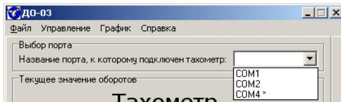
Рис. 25. Выбор последовательного порта для работы с прибором.
