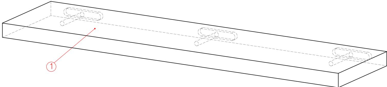
1. Разметить в стене отверстия для дюбеля и просверлить по схеме (см. ниже). Вбиты дюбели F1x6 в просверленые отверстия в стене (предварительно разметив точки сверления).
