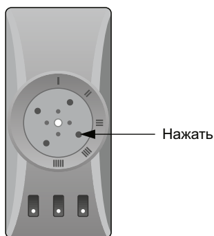
Рис. 3. Расположение штока на термовыключателе термостата.
