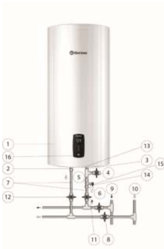
Рисунок 1. Схема подключения ЭВН к водопроводу
