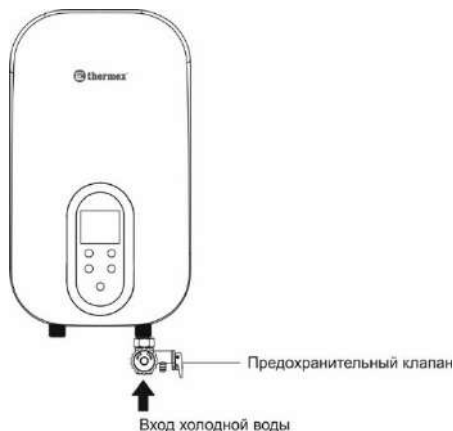
Рис.3 Установка предохранительного клапана
