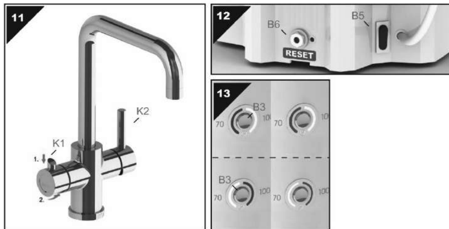
Рис. 5. Эксплуатация смесителя без смесительного клапана
