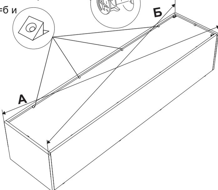
5. Прикрутите шурупами 4x30 навесы к боковинам №3. Установите шины монтажные на стену. (\*В комплекте не предусмотрена фурнитура для крепления шины монтажной к стене)
