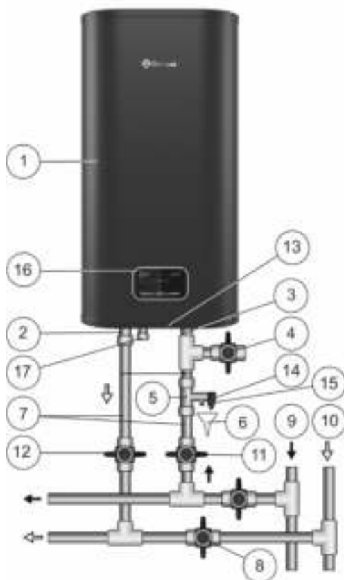
Рисунок 1. Схема подключения ЭВН к водопроводу в вертикальном положении вертикальных моделей V.
